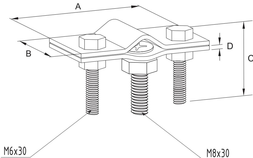
Предназначен для крепления токоотвода  $\varnothing 8-10$  мм
