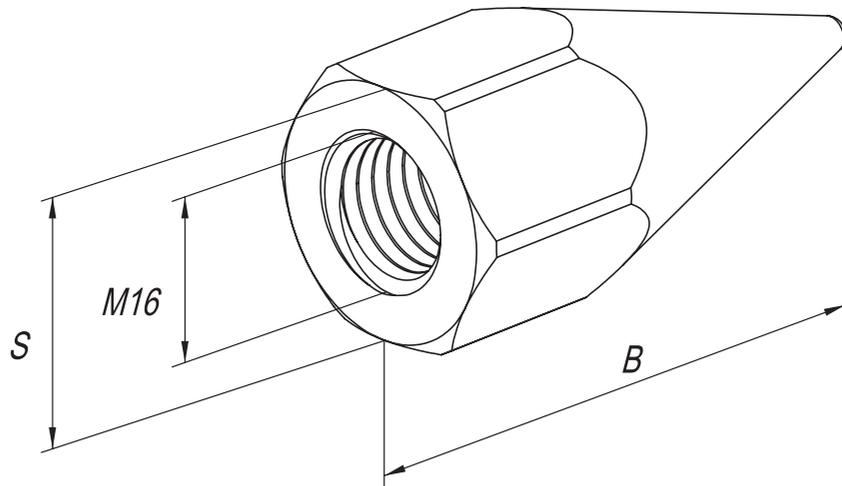
Служит для упрощения забивания вертикального стержневого заземлителя. Комплектуется к штырям (код 21020, 21050).
