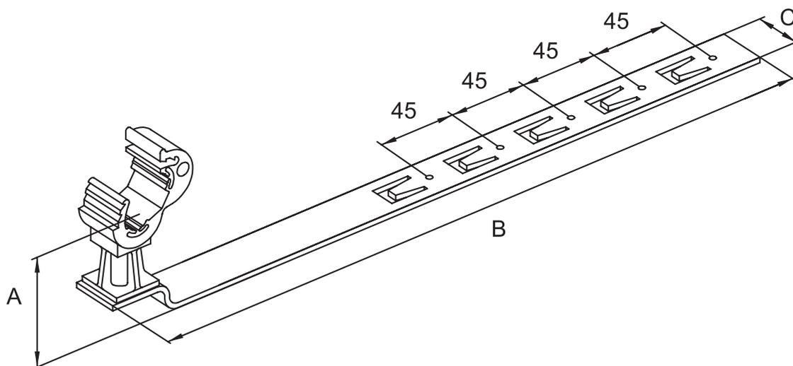
Держатель предназначен для фиксации токоотвода на черепичной кровле. Оснащен крючками для монтажа. Монтаж токоотвода осуществляется путем защелкивания держателя.
