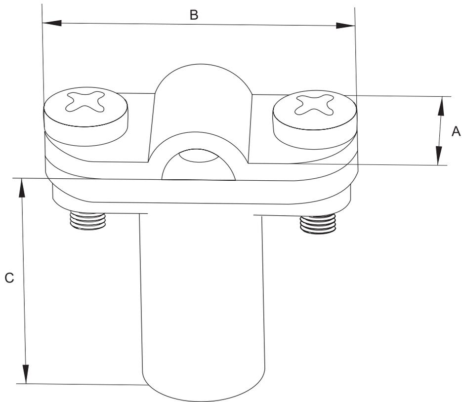
Предназначен для фиксации токоотвода  $\varnothing 8-10$  мм к кровле, фасаду здания.
