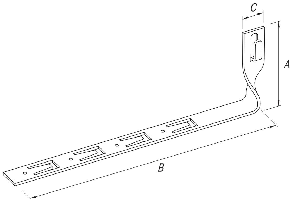
Предназначен для крепления токоотвода  $\varnothing 6-10$  мм на черепичной кровле. Оснащен крючками для монтажа.
