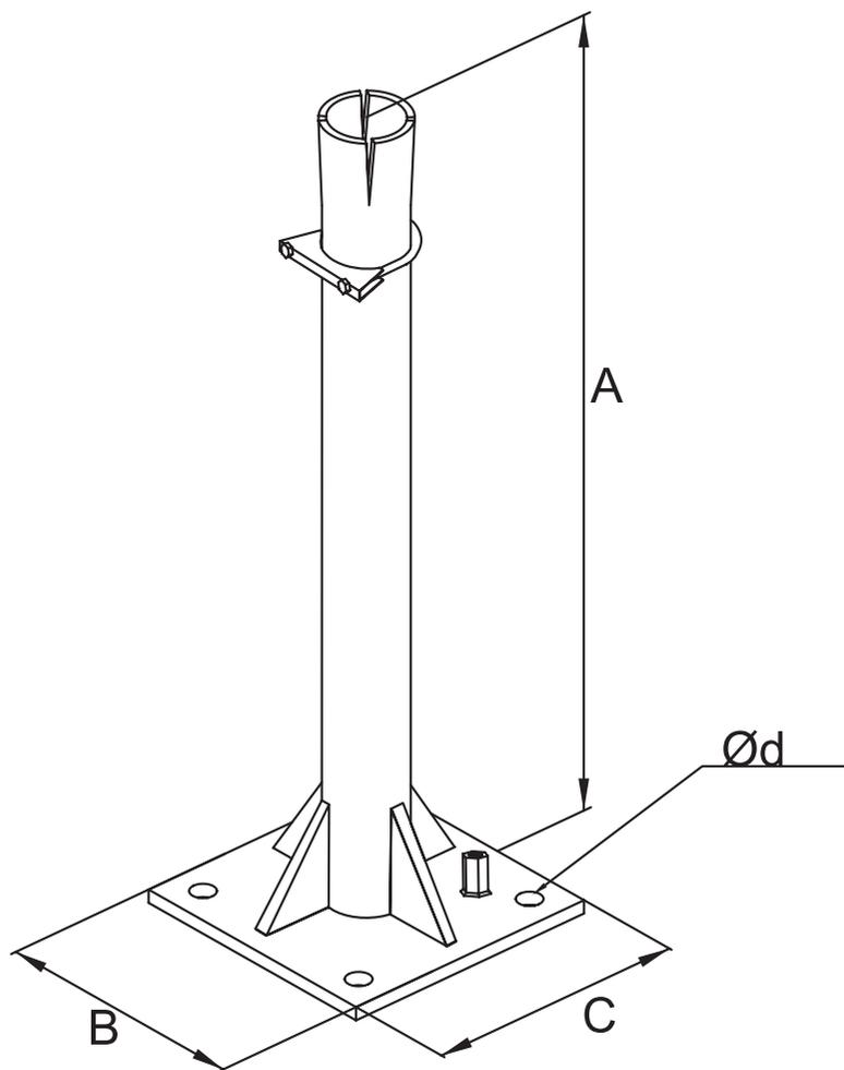
Предназначена для крепления мачты молниеприемника на горизонтальных поверхностях.
