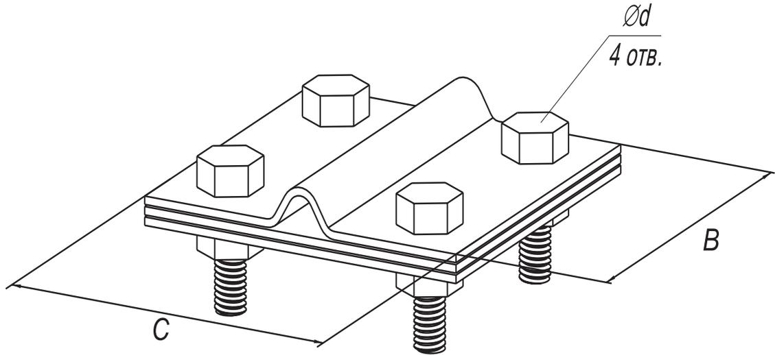
Служит для соединения прута  $\varnothing 6-10$  мм с полосой шириной до 40 мм.
