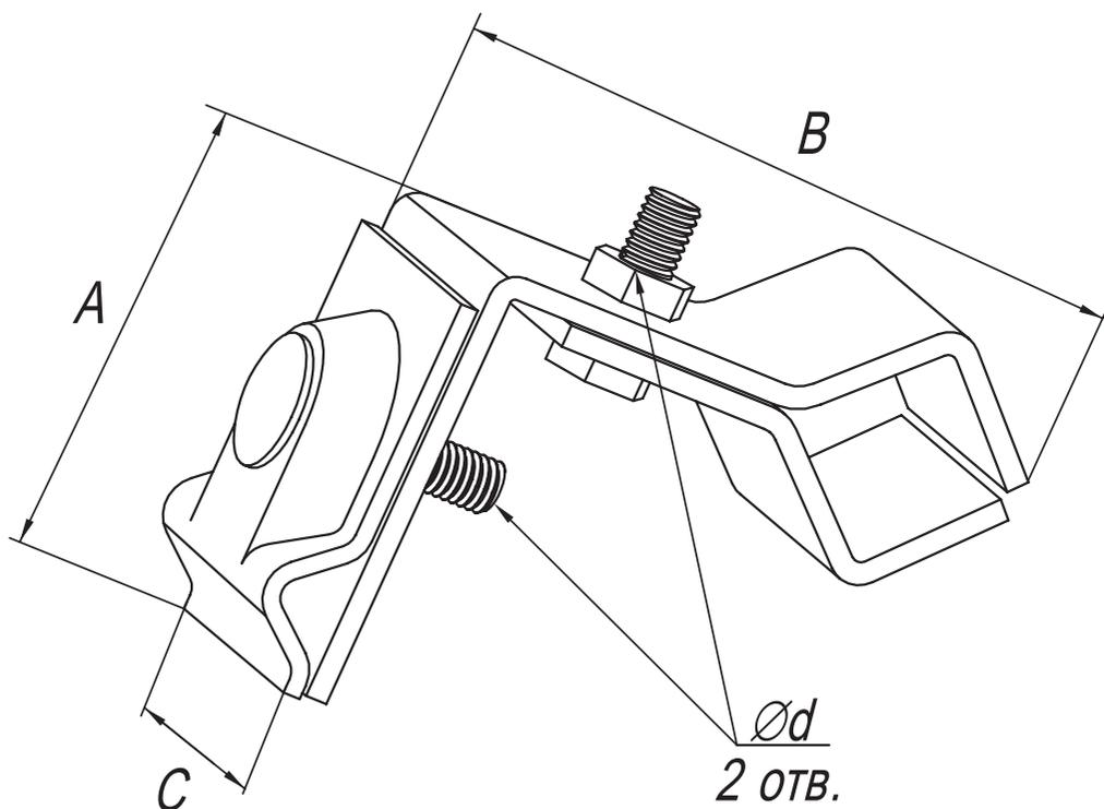
Предназначен для крепления токоотвода  $\varnothing 6-10$  мм к фальцевой кровле или листовой стали.
