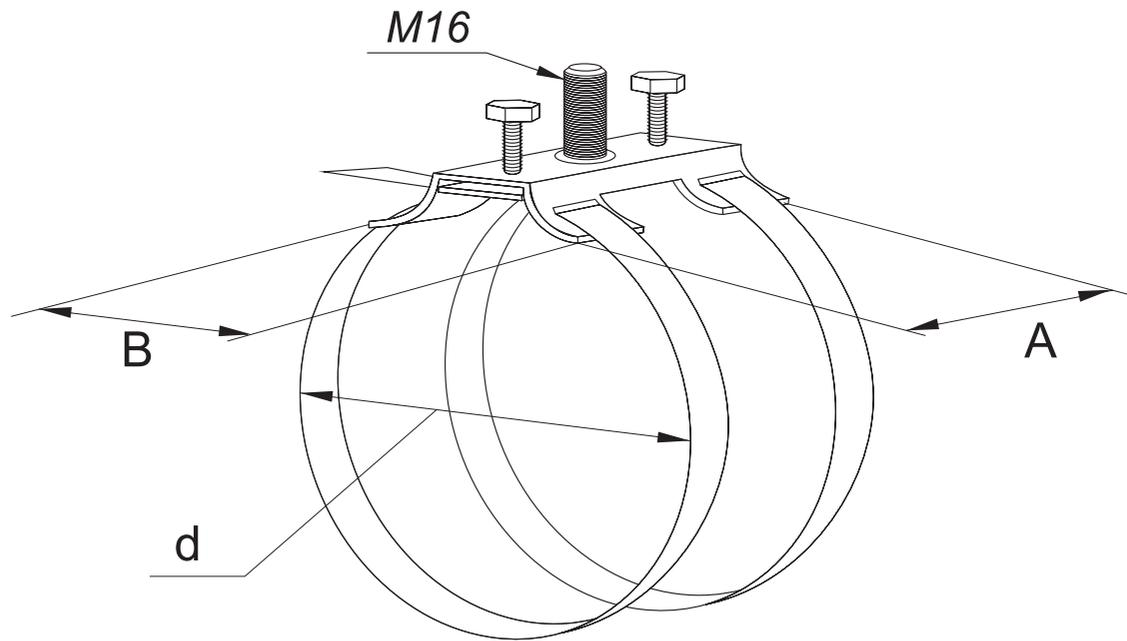
Предназначен для крепления штанги изоляционной к трубе.
