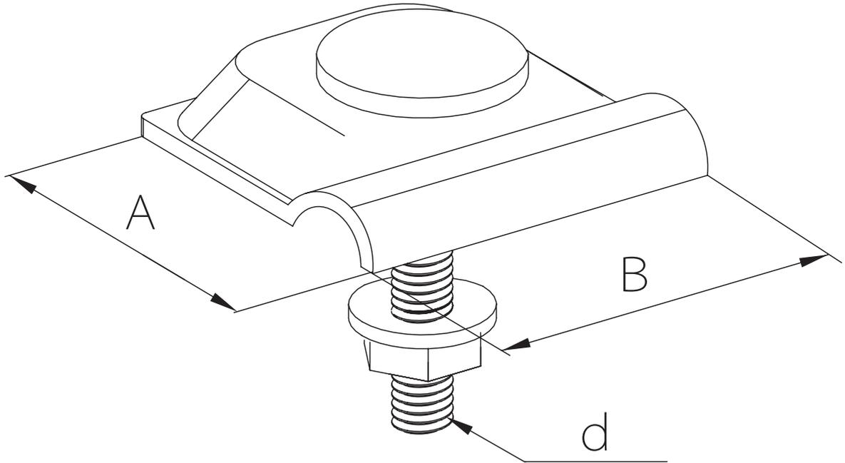
Предназначен для крепления токоотвода  $\varnothing 6-10$  мм к металлическим поверхностям.
