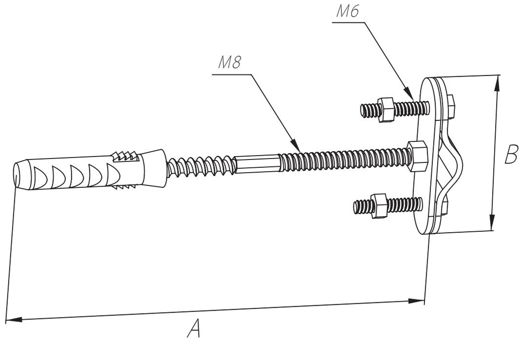
Предназначено для крепления молниеприемника (16-20 мм) к вертикальной конструкции здания.
