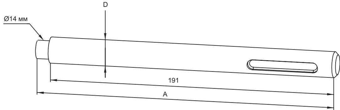
Предназначена для использования совместно с перфоратором SDS-Max для глубинной установки стержней заземления.
