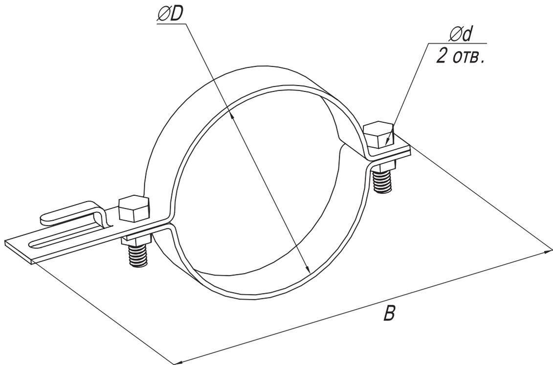
Предназначен для крепления токоотвода Ø6-10 мм к водосточной трубе.
