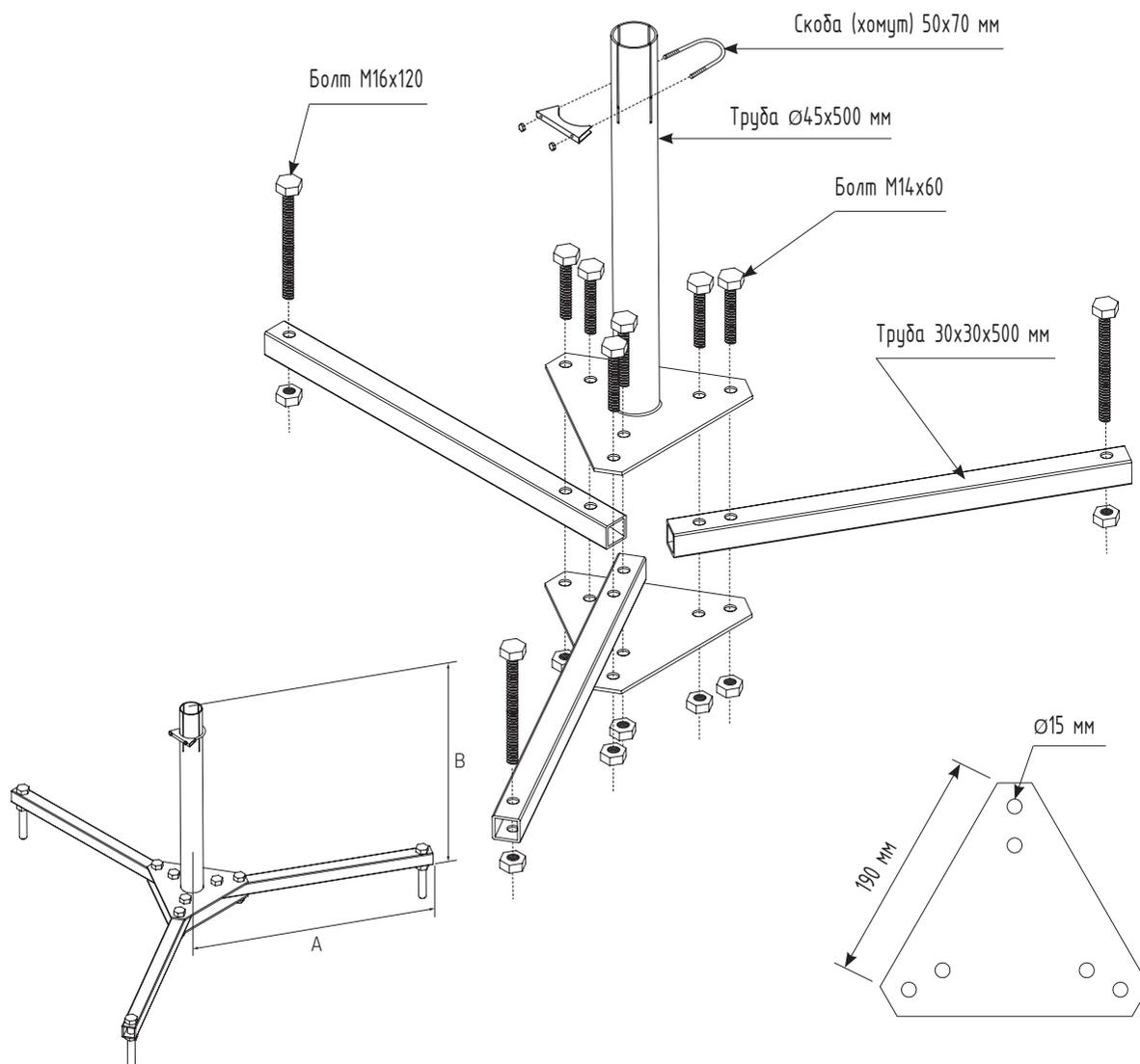
Предназначена для установки молниеприемников высотой от 5 до 7 м. Используется с бетонными основаниями 03003 – 3 шт.
