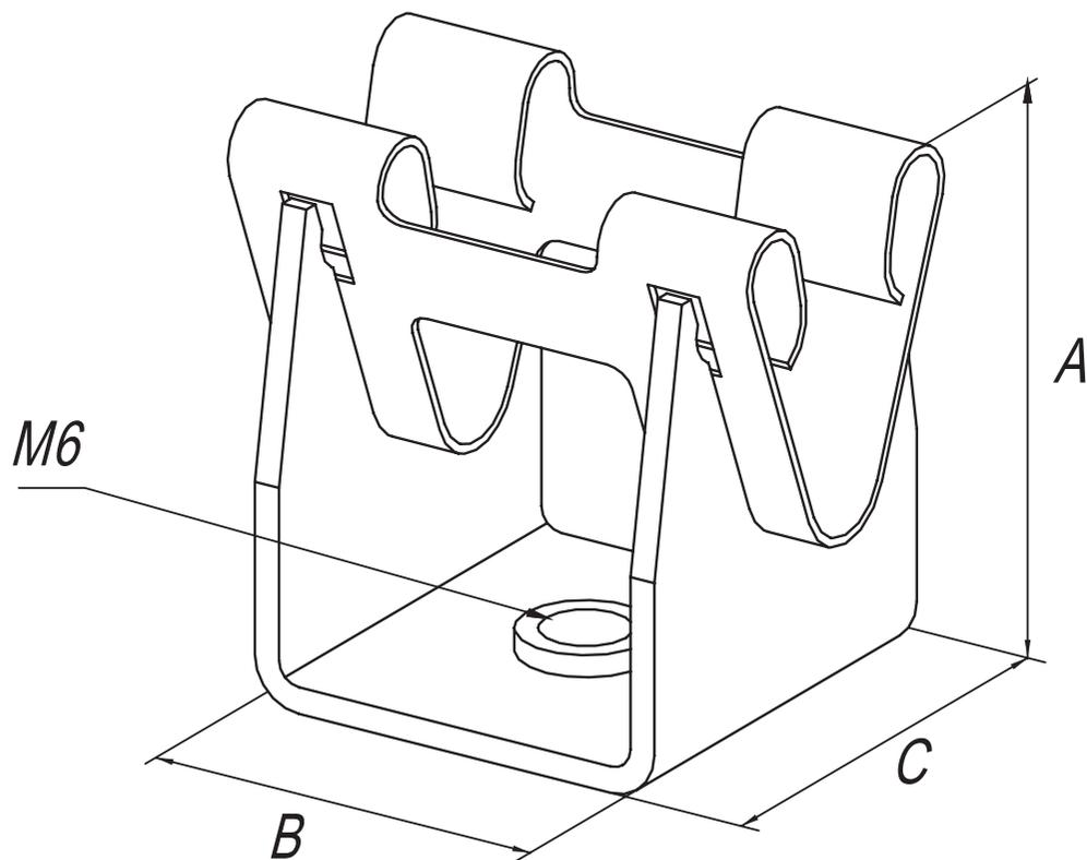
Предназначен для фиксации токоотвода  $\varnothing 8-10$  мм на фасаде здания. Монтаж токоотвода осуществляется путем его защелкивания.
