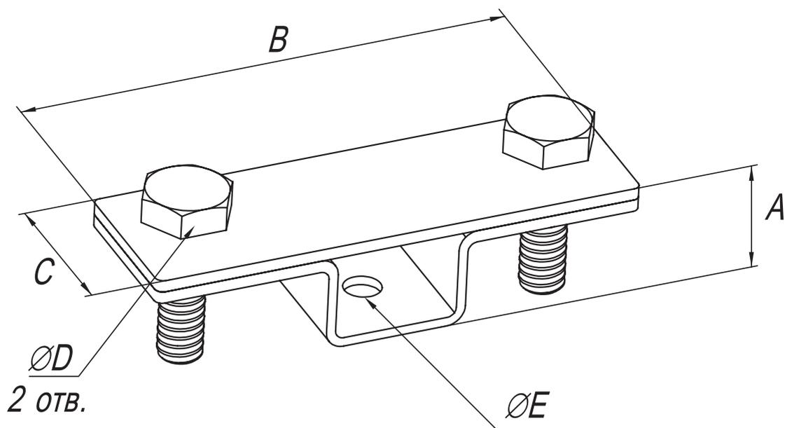
Предназначен для крепления полосы до 40 мм к стене здания.
