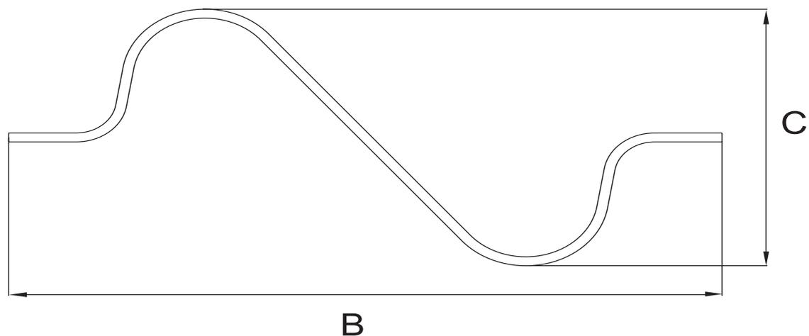
Предназначен для выравнивания длины токоотвода, деформированного в результате температурного воздействия. Для круглых проводников.
