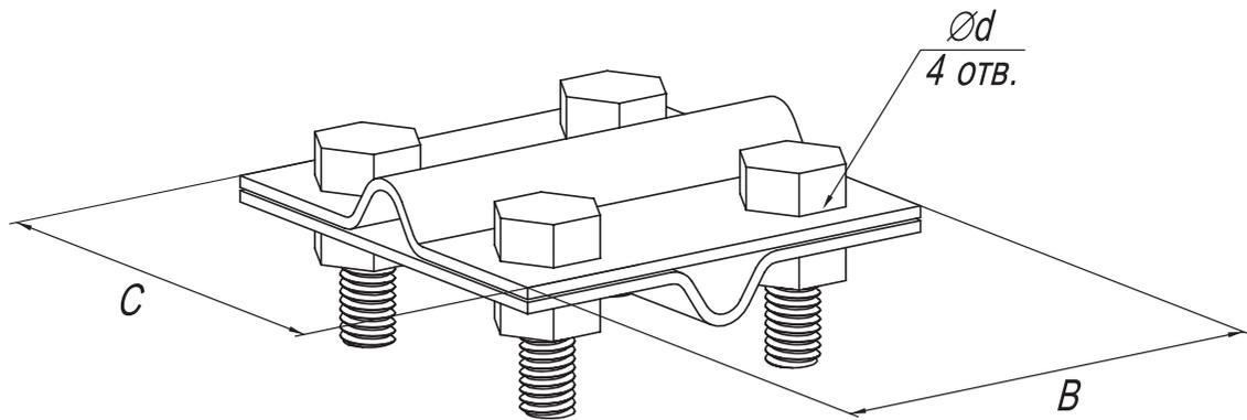
Предназначен для параллельного либо перпендикулярного соединения токопровода Ø6-10 мм.
