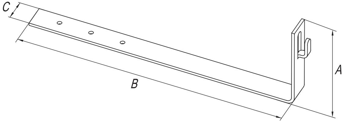
Предназначен для крепления токоотвода  $\varnothing 6-10$  мм на черепичной кровле.
