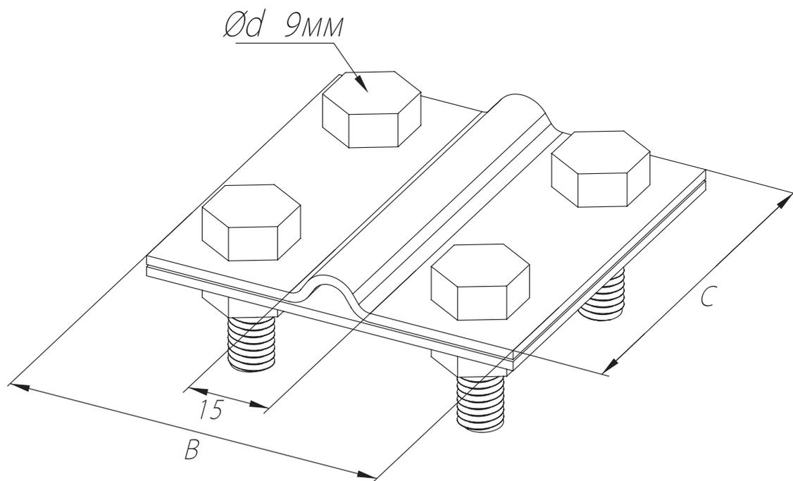
Служит для соединения прута  $\varnothing 6-10$  мм с полосой шириной до 40 мм.
