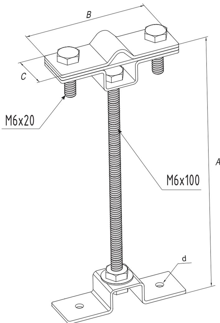
Предназначен для крепления токоотвода  $\varnothing 8-20$  мм.
