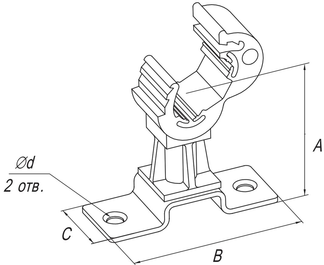
Предназначен для фиксации токоотвода  $\varnothing 8-10$  мм на коньке черепичной кровли. Монтаж токоотвода осуществляется путем защелкивания держателя.
