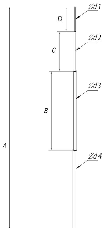
Предназначена для установки совместно с бетонными основаниями 03003 в компоновке с опорой 04009. Конструкция телескопическая составная. В комплект включены тросы для крепления мачты.
