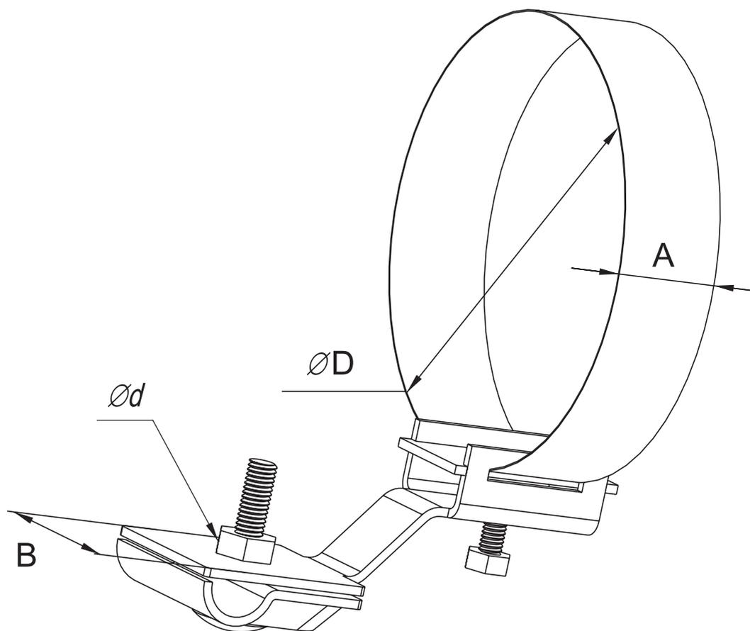
Предназначен для крепления токоотвода  $\varnothing 6-10$  мм к водосточной трубе.
