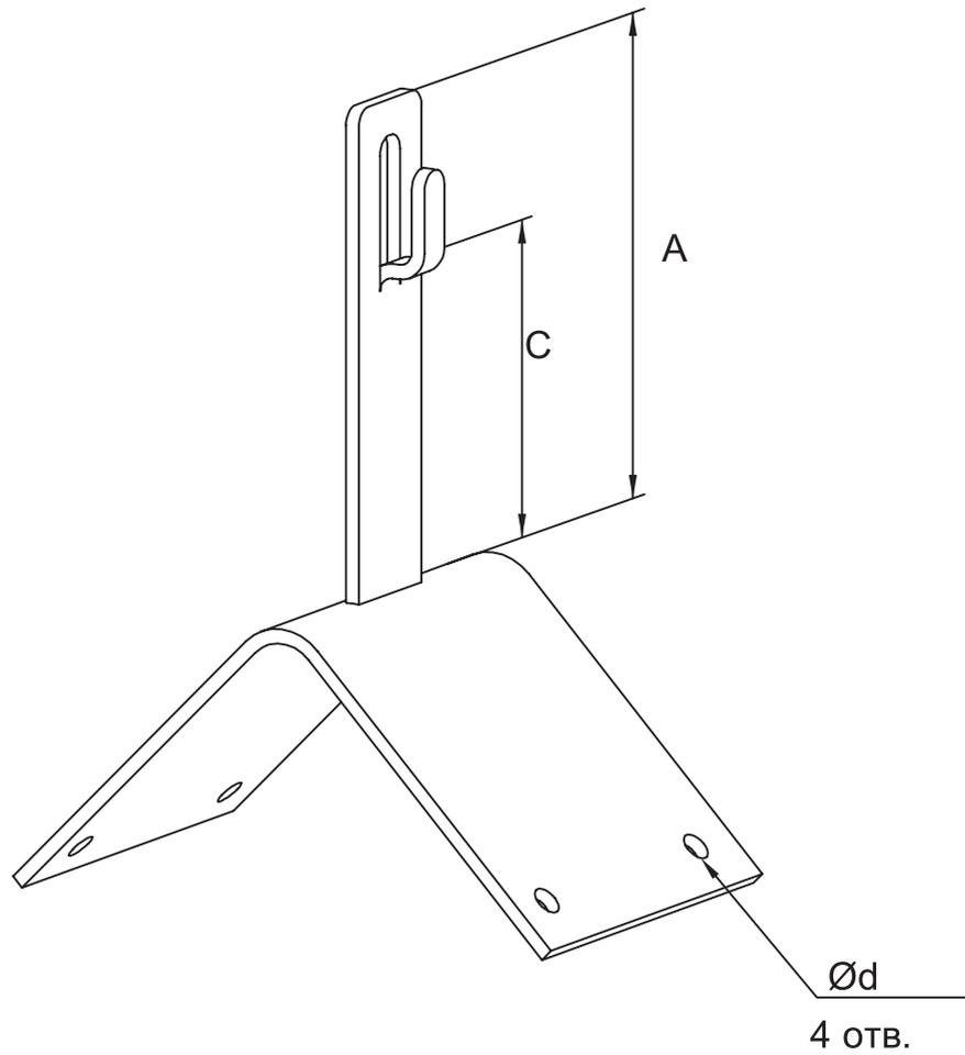
Предназначен для крепления токоотвода Ø6-10 мм на коньке крыши.
