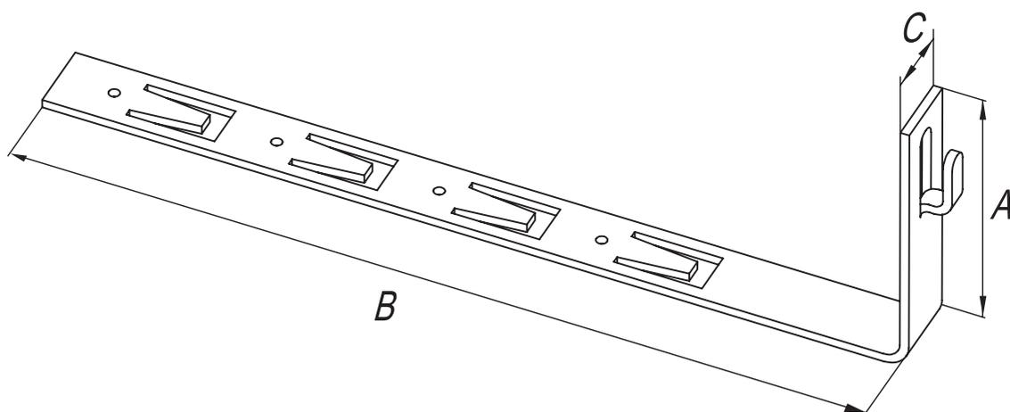
Предназначен для крепления токоотвода  $\varnothing 6-10$  мм на черепичной кровле. Оснащен крючками для монтажа.
