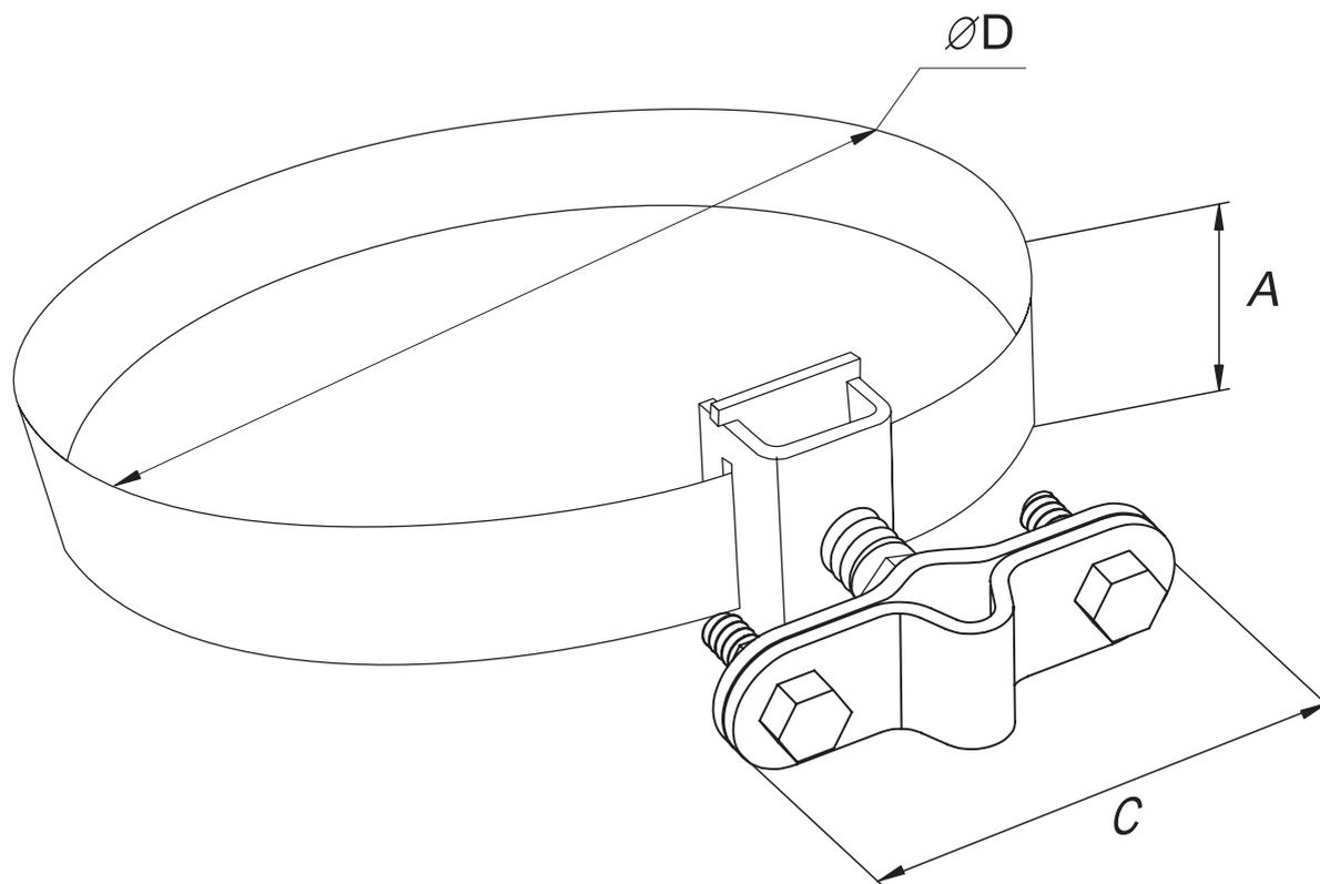
Предназначен для крепления токоотвода  $\varnothing 6-10$  мм к различным элементам конструкции здания.
