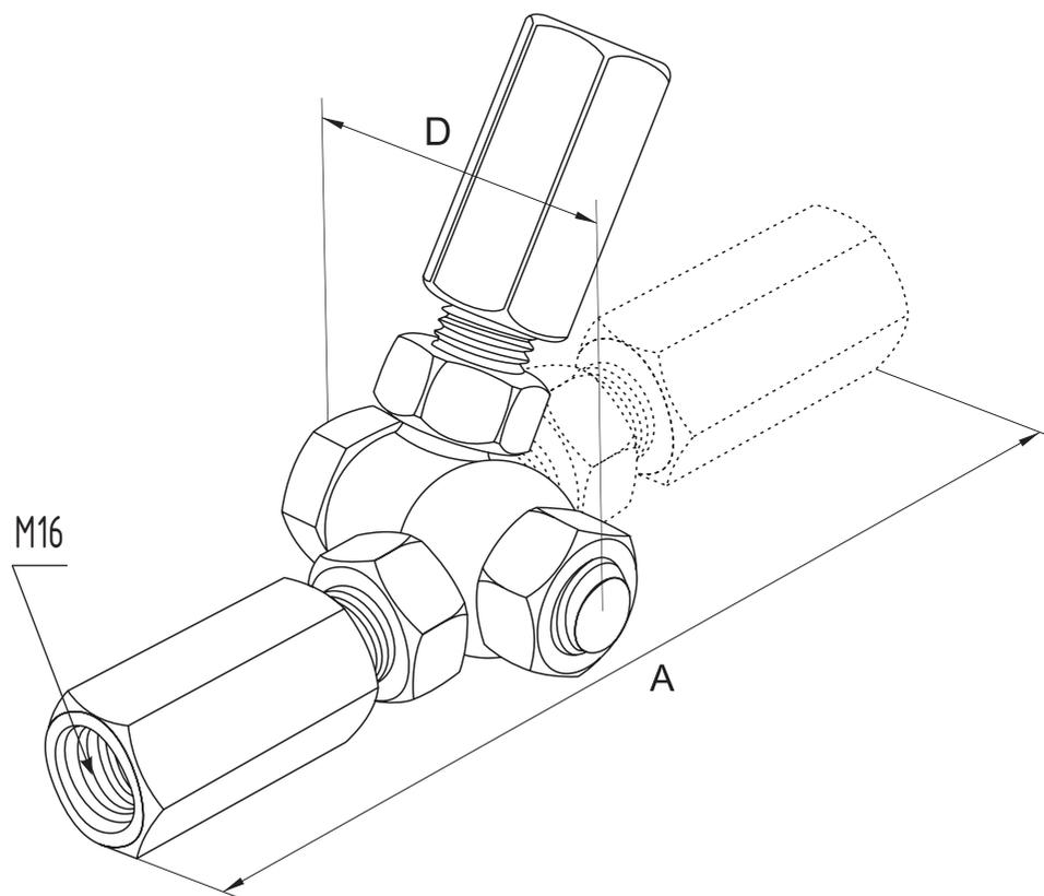
Предназначено для установки на скат кровли молниеприемников высотой 1-2 м (код 11000, 11500, 12000).
