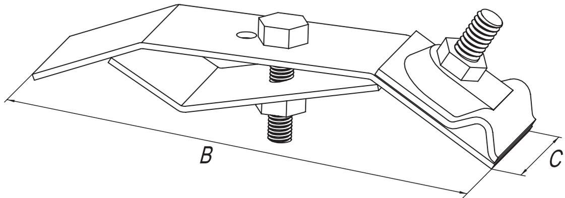
Предназначен для крепления токопровода  $\varnothing 6-10$  мм на водосточном желобе.
