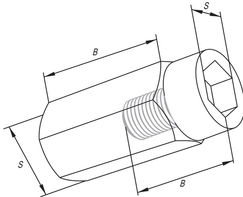
Монтажный комплект применяется при монтаже системы заземления для присоединения штыря заземления к перфоратору. Винт и гайка принимают основную ударную осевую нагрузку на себя, являются расходным материалом.
