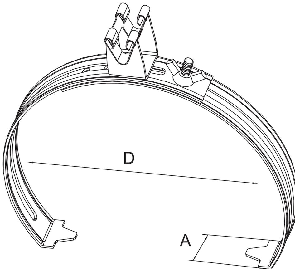
Предназначен для фиксации токоотвода  $\varnothing 8$  мм на коньке черепичной кровли. Монтаж токоотвода осуществляется путем его защелкивания.
