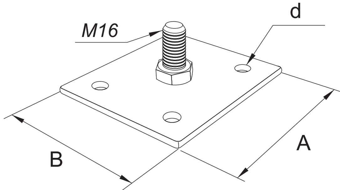
Предназначена для крепления штанги изоляционной к строительным конструкциям.
