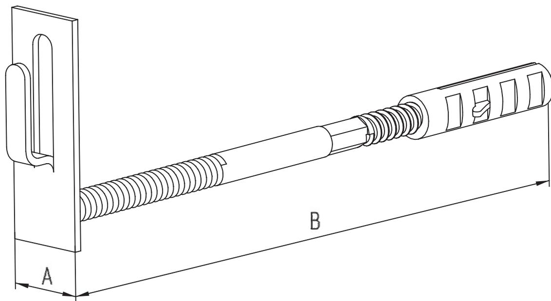
Предназначен для крепления токоотвода  $\varnothing 6-10$  мм к фасаду здания.
