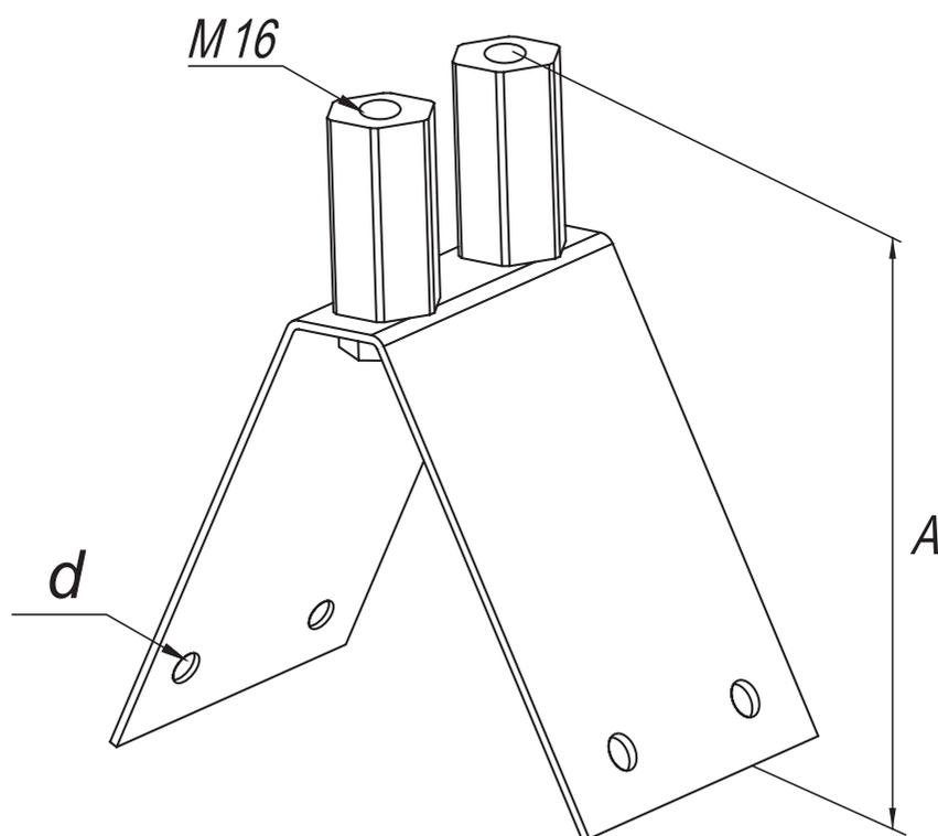
Предназначено для установки на конек молниеприемников высотой 1-2 м (код 02002)
