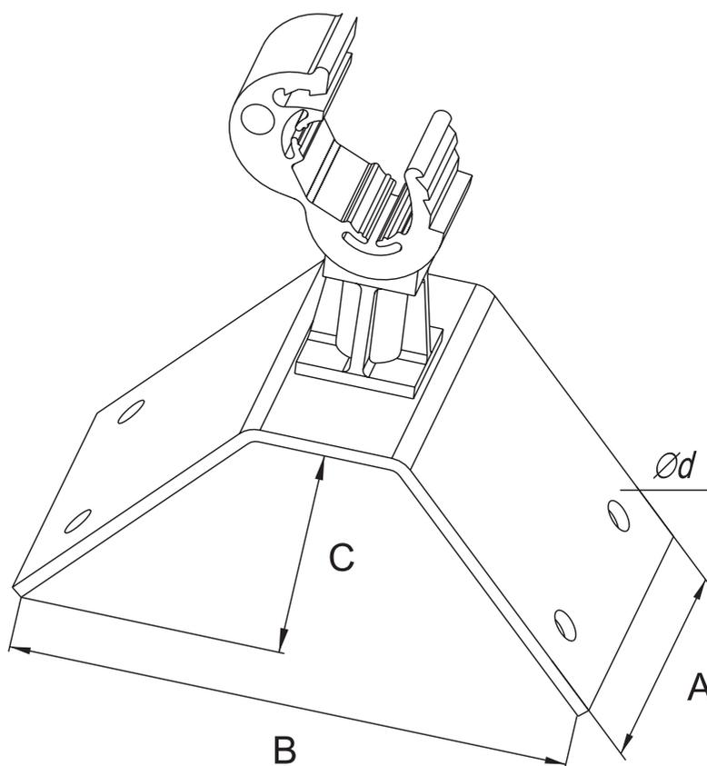
Предназначен для фиксации токоотвода  $\varnothing 8-10$  мм на коньке крыши. Высота крепления прута от конька – 30 мм. Монтаж токоотвода осуществляется путем защелкивания держателя.
