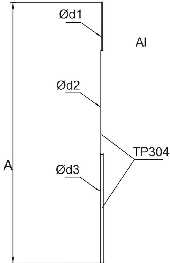
Предназначена для защиты от разряда молнии отдельностоящих элементов, расположенных на крышах зданий. Конструкция телескопическая составная.
