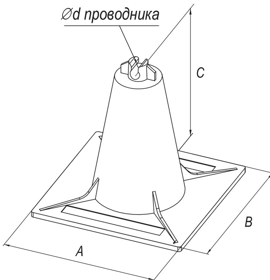
Предназначен для фиксации токоотвода на плоской мягкой кровле.
