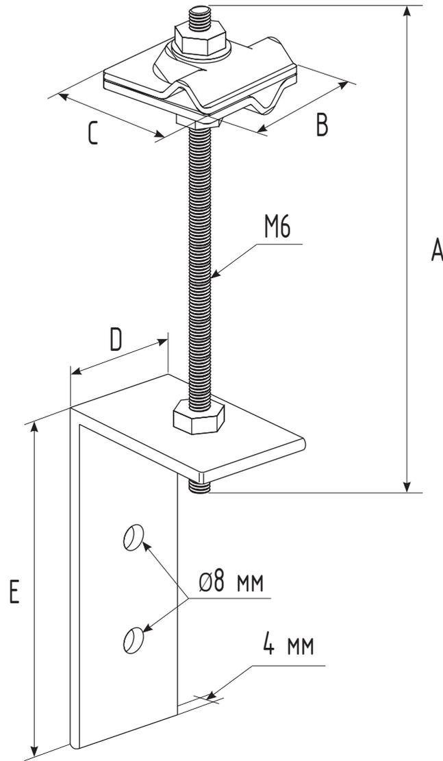
Предназначен для фиксации токоотвода Ø8-10 мм на парапетах.
