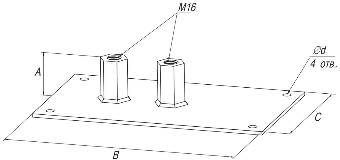
Предназначена для установки на плоской кровле молниеприемников высотой 1-2 м (арт. 04004); 3-4 м (арт. 04005).
