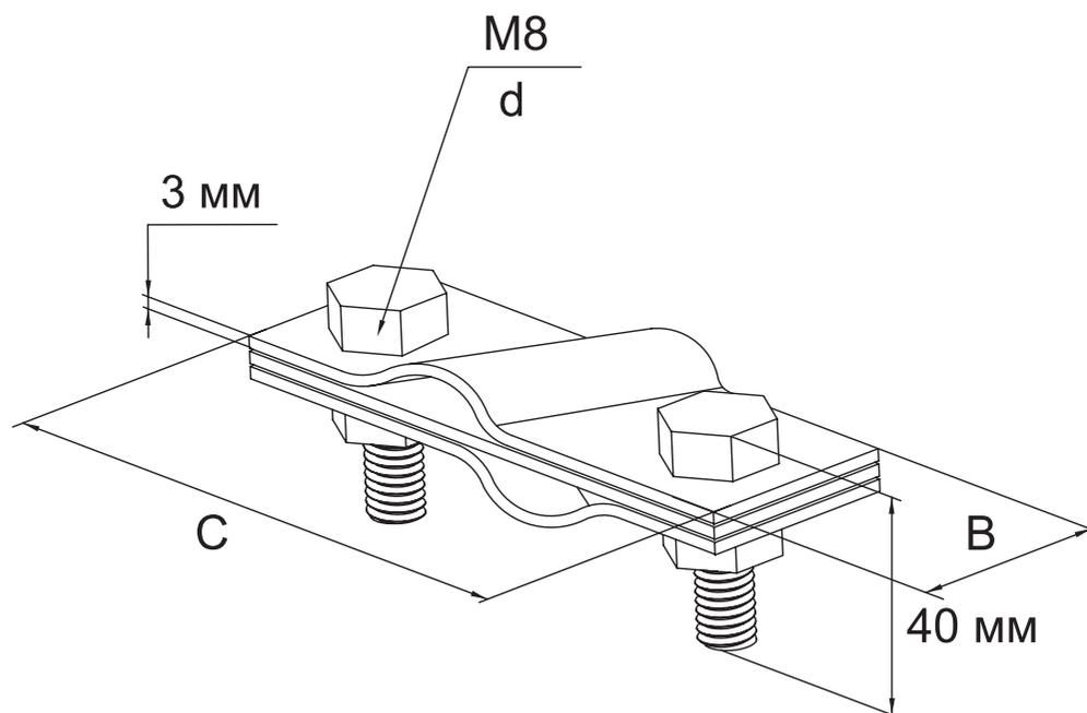
Предназначен для соединения штыря заземления  $\varnothing 16$  мм с прутом  $\varnothing 8-12$  мм и/или полосой до 40 мм.
