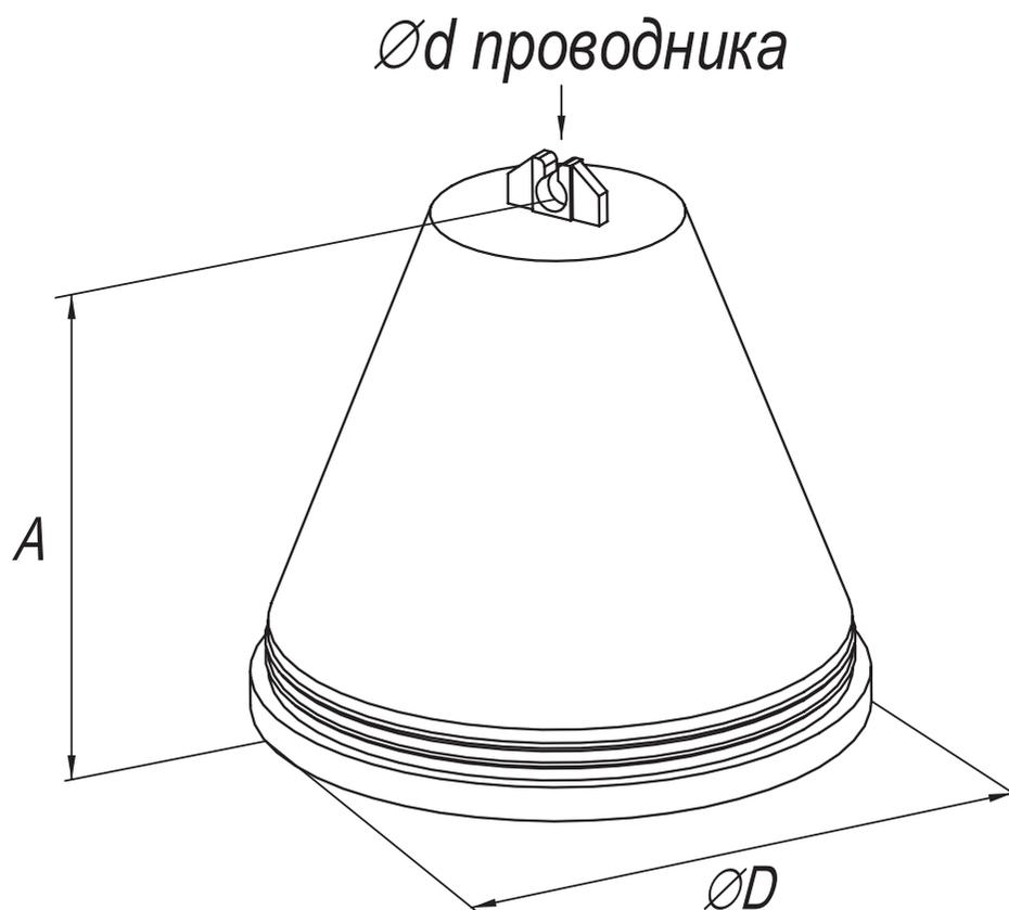
Предназначен для фиксации токопровода 8-12 мм на плоской кровле.
