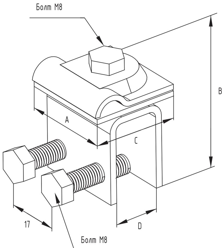
Предназначен для крепления токоотвода  $\varnothing 6-10$  мм к фальцевой кровле или листовой стали толщиной до 12 мм.
