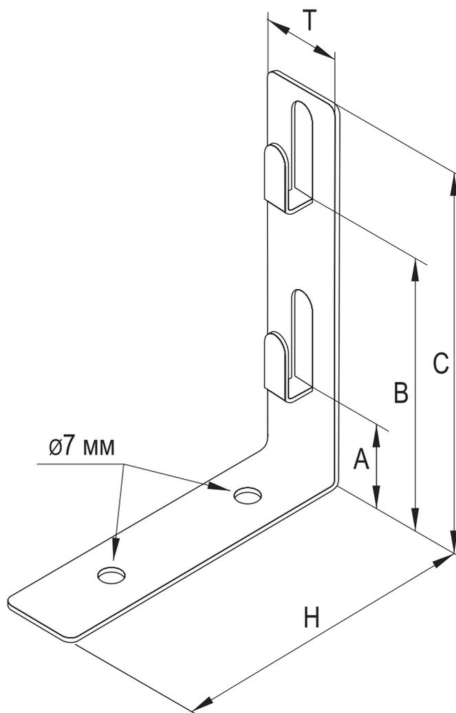
Предназначен для крепления токоотвода  $\varnothing 6-10$  мм.
