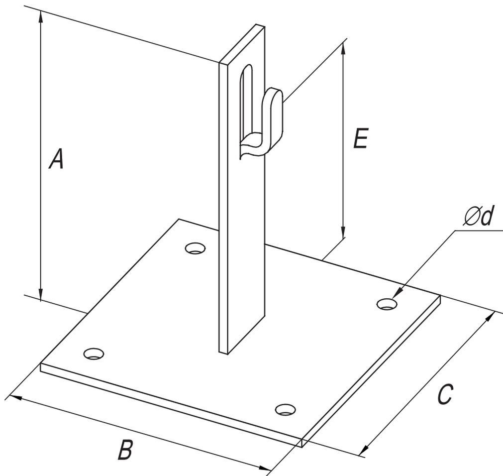
Предназначен для крепления токоотвода  $\varnothing 6-10$  мм на плоской кровле, на парапете.
