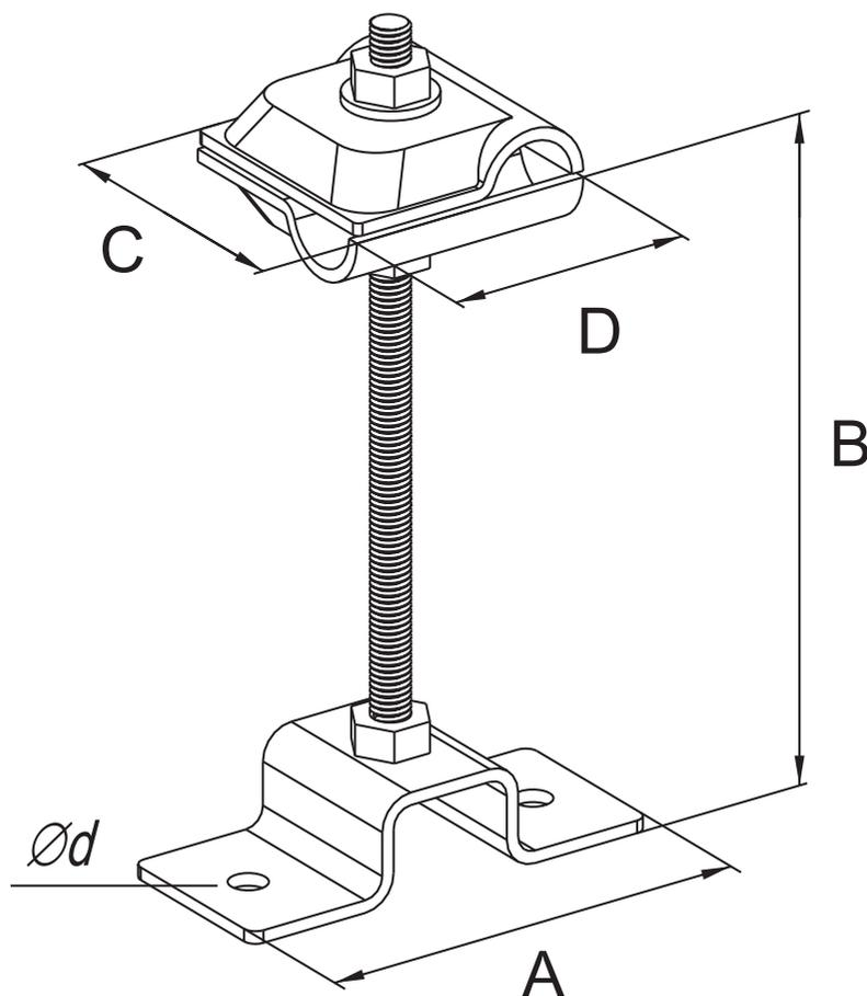
Предназначен для крепления токоотвода  $\varnothing 6-10$  мм
