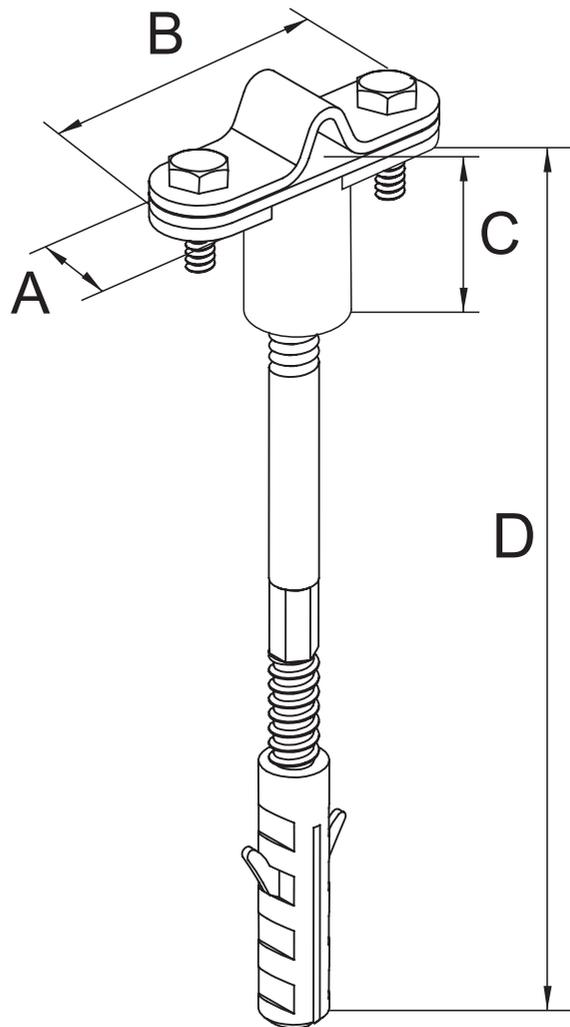
Служит для фиксации токоотвода  $\varnothing 8-10$  мм к поверхности сэндвич-панели.
