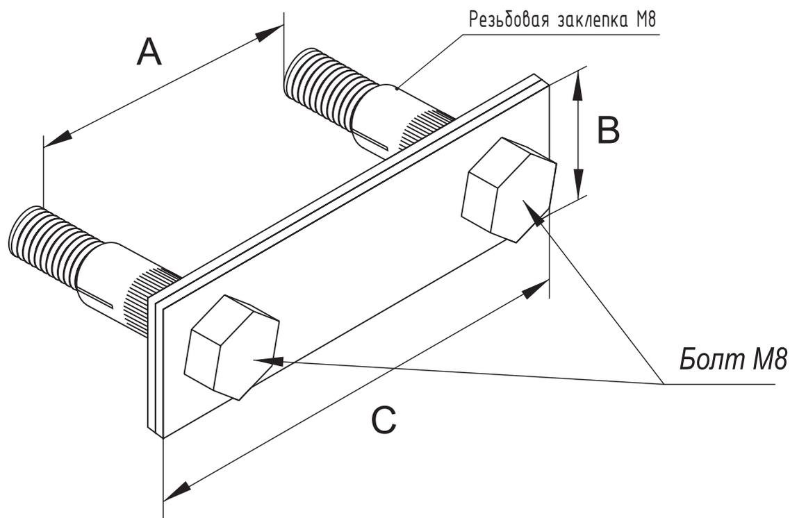
Предназначен для крепления полосы шириной до 50 мм по поверхности тонколистового металлического основания.
