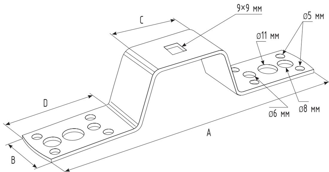
Предназначена для присоединения токопроводящих кровельных элементов с возможностью закрепить на ней токоотвод 8-10 мм с помощью зажима прижимного арт. 51520 и арт. 51525
