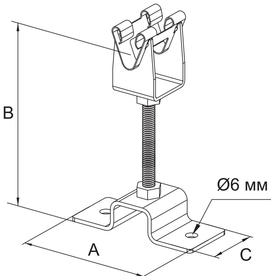
Предназначен для фиксации токоотвода Ø8 мм к поверхности сэндвич-панели. Монтаж токоотвода осуществляется путем его защелкивания.
