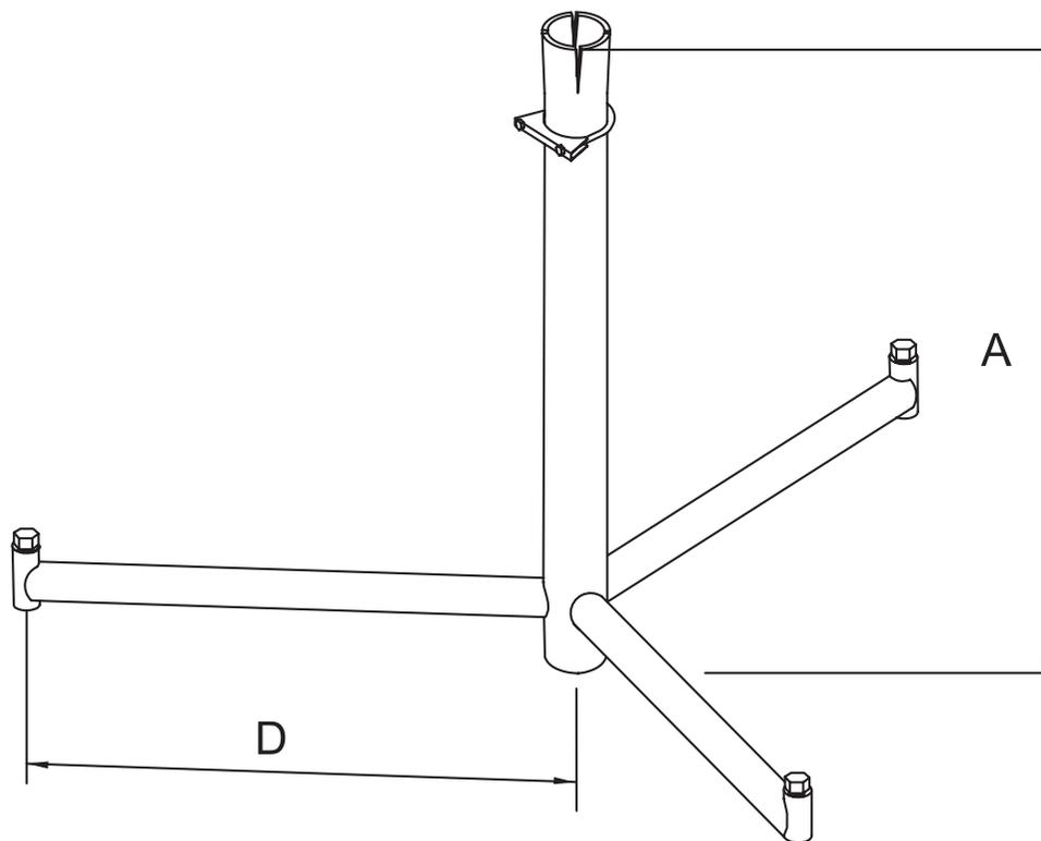
Предназначена для установки молниеприемников высотой от 5 до 7 м.
