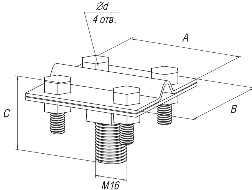
Предназначен для зажима прута  $\varnothing 6-10$  мм или полосы до 30 мм на штыре  $\varnothing 16$  мм, а также для крепления токоотвода к молниеприемному стержню, бетонному основанию (арт. 02002, 03003), совместно с держателями (арт. 04004, 04005, 04007, 04007SP, 04008).
