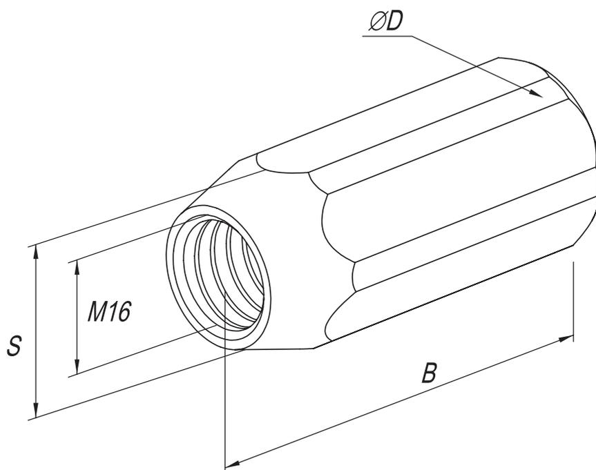
Служит для соединения штырей заземления или штыря с ударным болтом. Главная функция – обеспечение надежного соединения штырей между собой.
