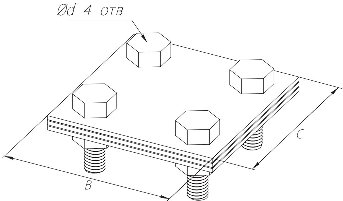
Предназначен для параллельного или перпендикулярного соединения полосы до 40 мм.
