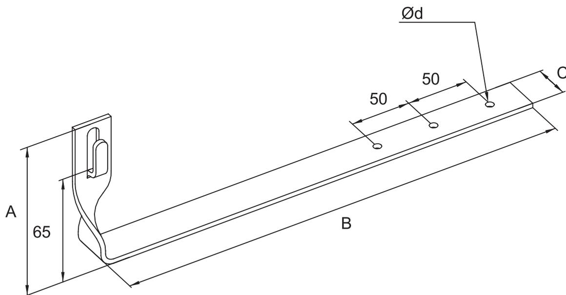
Предназначен для крепления токоотвода  $\varnothing 6-10$  мм на черепичной кровле.
