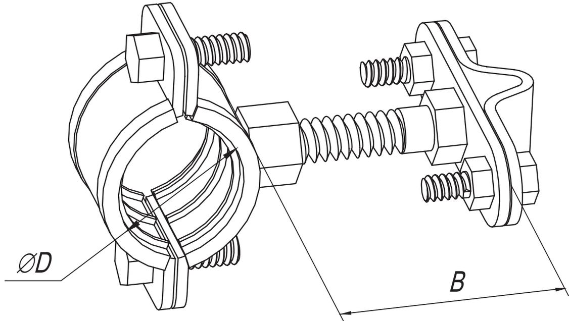
Предназначен для крепления токоотвода Ø6-10 мм на трубе.
