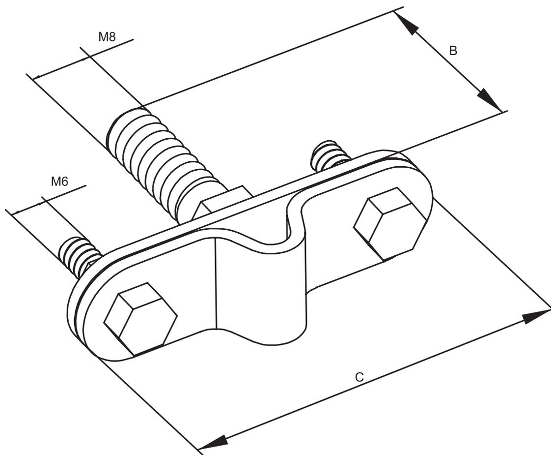
Предназначен для крепления токоотвода  $\varnothing 6-10$  мм к стене здания.
