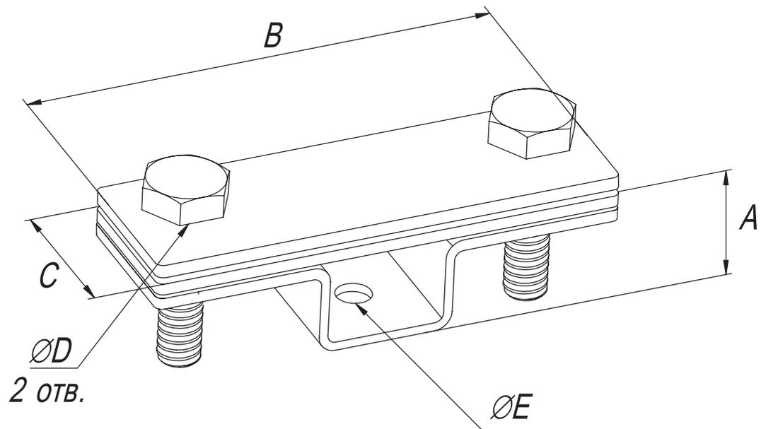
Предназначен для крепления полосы до 40 мм к стене здания.
