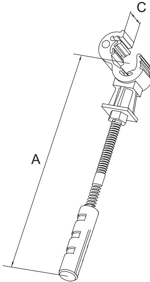
Служит для фиксации токоотвода Ш8-10 мм к фасаду здания.
