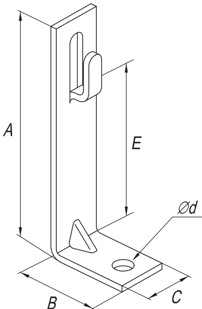
Предназначен для крепления токоотвода  $\varnothing 6-10$  мм на кровле.
