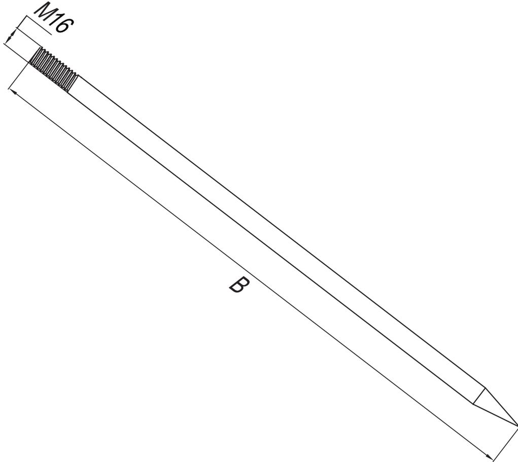
Используется при выполнении вертикального заземления.
