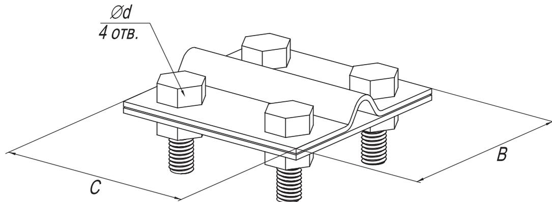
Предназначен для параллельного и перпендикулярного соединения прута  $\varnothing 6-10$  мм с полосой шириной до 30 мм.
