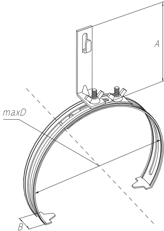
Предназначен для фиксации токоотвода  $\varnothing 6-10$  мм на коньке черепичной кровли.
