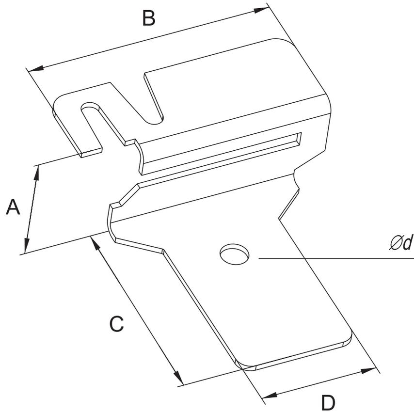
Предназначен для крепления полосы 4x25, 4x40 или прута  $\varnothing 8-10$  мм.
