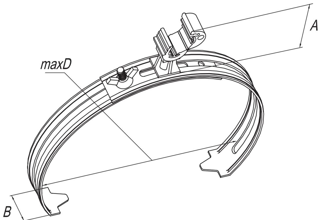
Предназначен для фиксации токоотвода  $\varnothing 8-10$  мм на коньке черепичной кровли. Монтаж токоотвода осуществляется путем защелкивания держателя.
