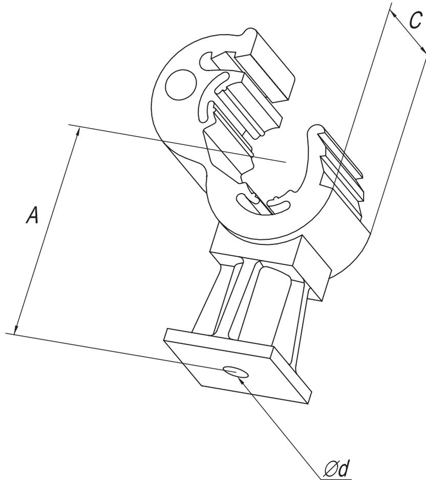
Предназначен для фиксации токоотвода  $\varnothing 8-10$  мм к кровле, фасаду здания. Монтаж токоотвода осуществляется путем защелкивания держателя.
