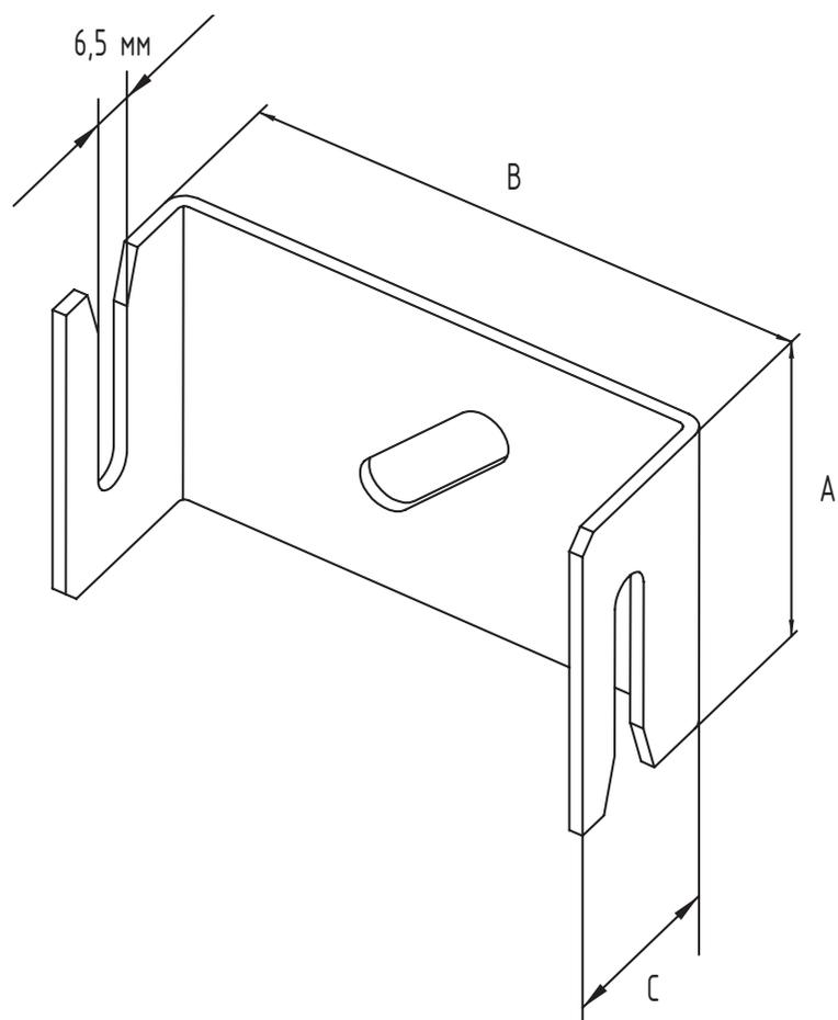
Предназначен для фиксации полосы 4x25; 4x30; 4x40; 5x40 мм на стене здания.
