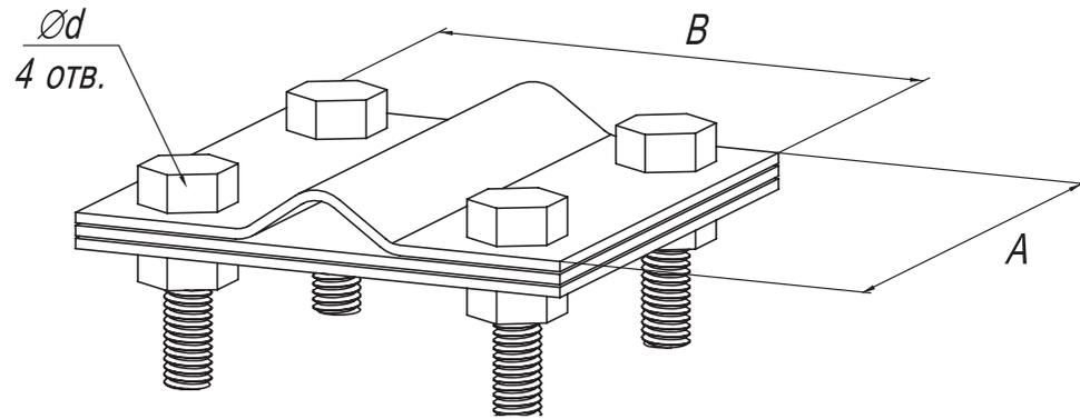
Предназначен для соединения штыря заземлителя  $\varnothing 12-20$  мм с полосой шириной до 50 мм.
