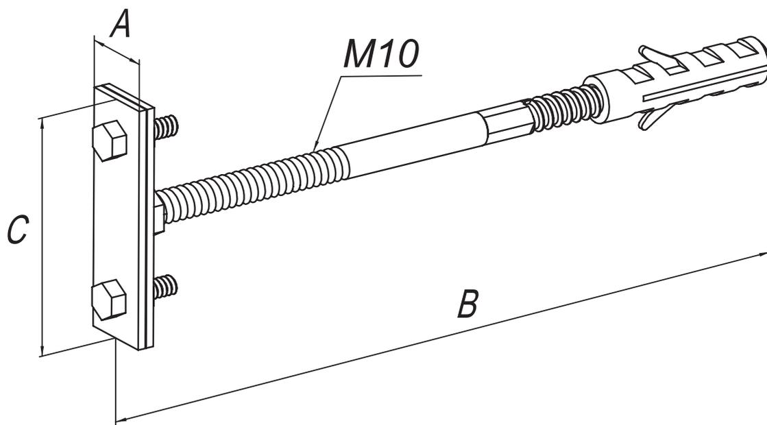
Предназначен для крепления полосы до 50 мм к стене здания.
