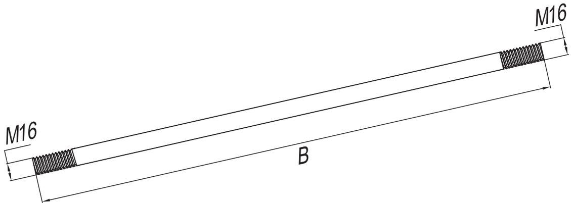
Используется при выполнении вертикального заземления.
