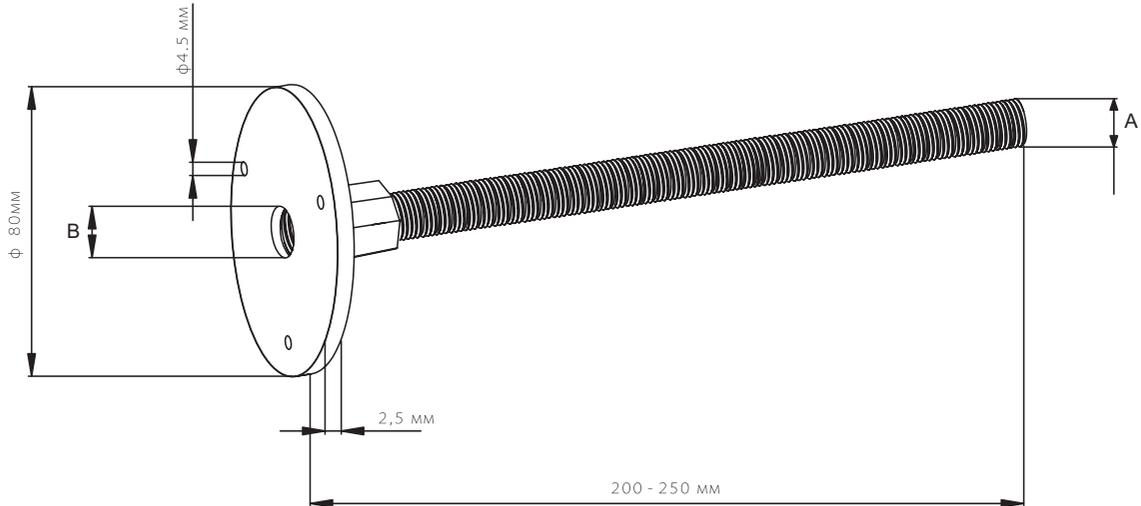
Предназначена для соединения заземления с арматурой здания.
