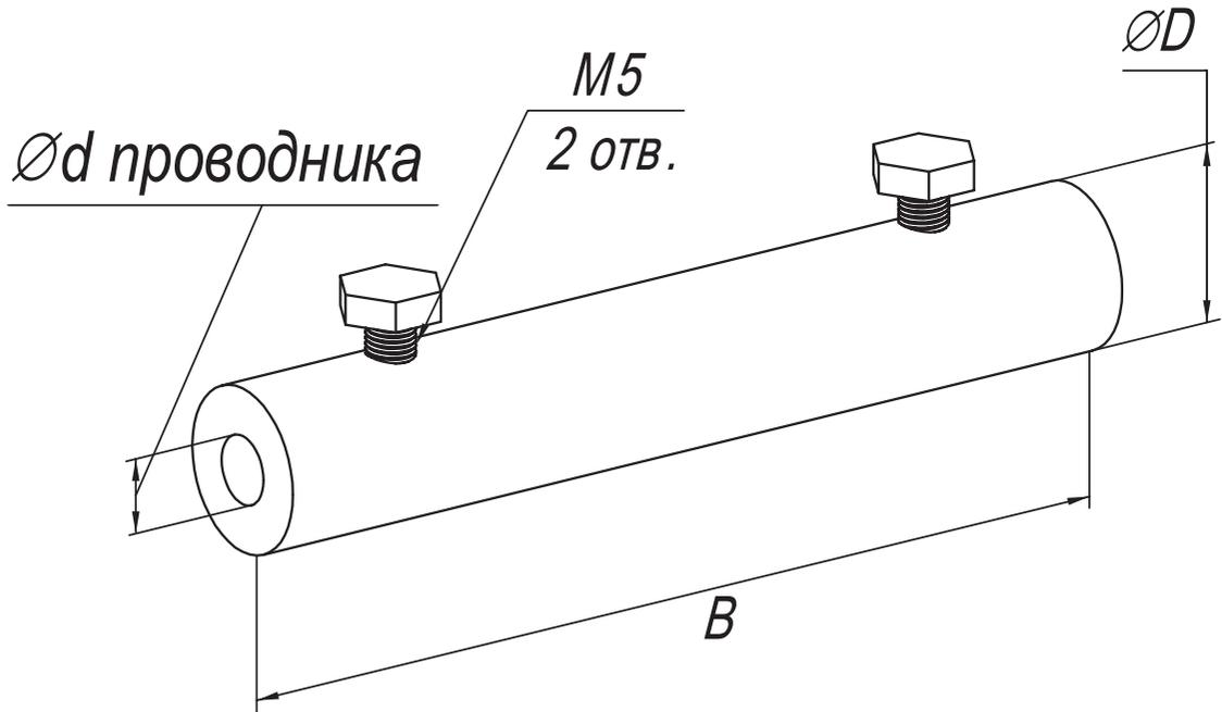
Предназначен для продольного соединения токоотвода.
