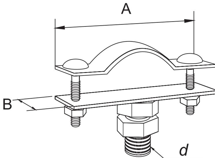
Предназначен для монтажа молниеприемника к строительным конструкциям через изоляционную штангу.
