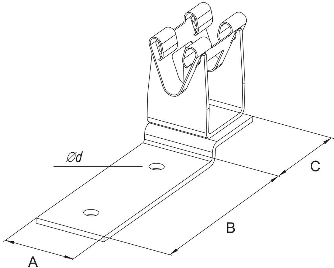
Держатель служит для фиксации токоотвода  $\varnothing 8$  мм на кровле. Монтаж токоотвода осуществляется путем его защелкивания.
