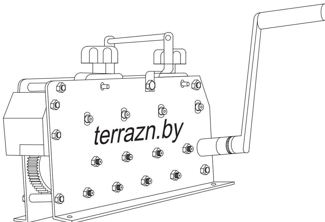
Устройство с ручным приводом для выравнивания проволоки
