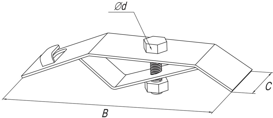
Предназначен для крепления токоотвода Ø6-10 мм на водосточном желобе.
