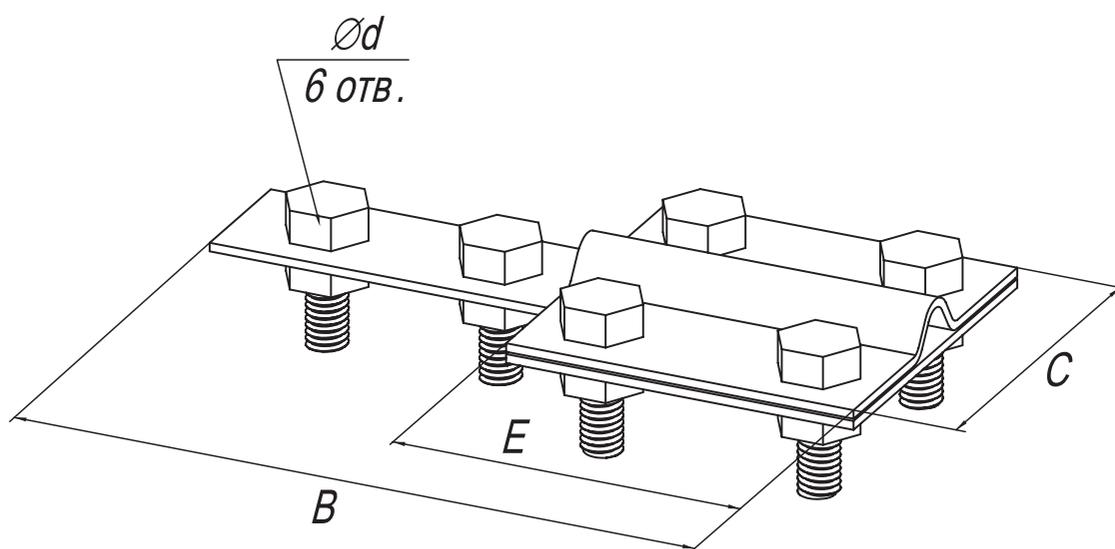
Предназначен для контрольного соединения прута  $\varnothing 6-10$  мм с полосой.
