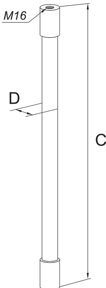
Штанга изоляционная для молниеприемников с креплением к стене предназначена для крепления молниеприемника до 3 м к вертикальной конструкции здания.
