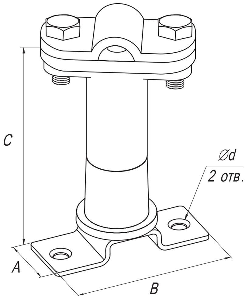
Служит для фиксации токоотвода  $\varnothing 8-10$  мм к поверхности сэндвич-панели.
