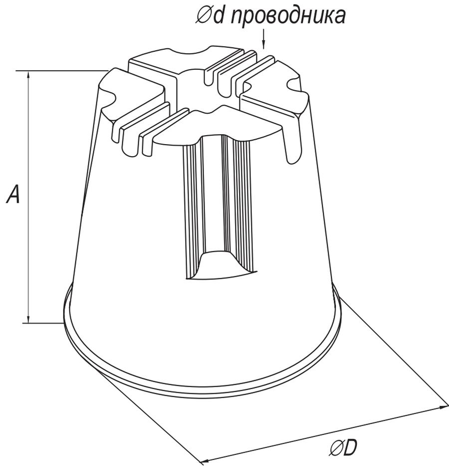
Предназначен для фиксации токопровода Ø8-10 мм на плоской кровле
