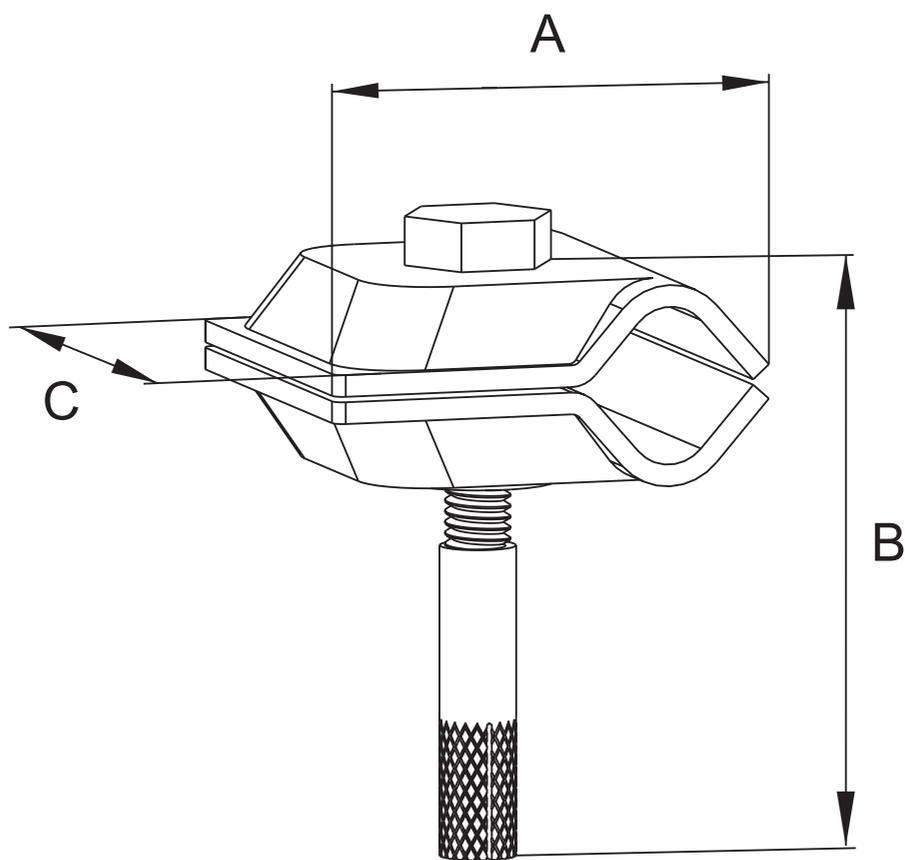
Предназначен для крепления токоотвода  $\varnothing 6-10$  мм на фасаде здания.
