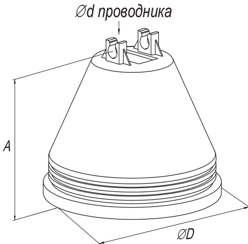
Предназначен для фиксации токоотвода на плоской кровле.
