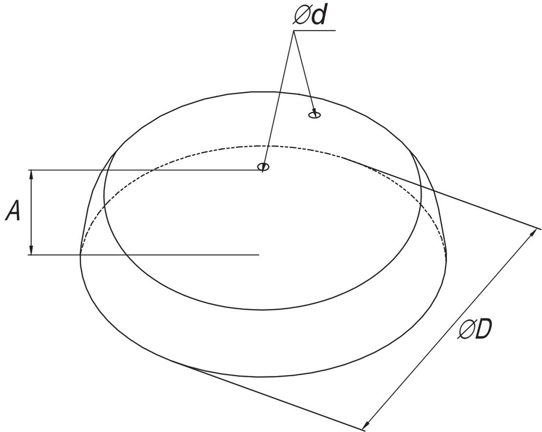
Предназначено для установки на плоской кровле молниеприемников высотой 1-2 м (код 02002), 3-4 м (код 03003)
